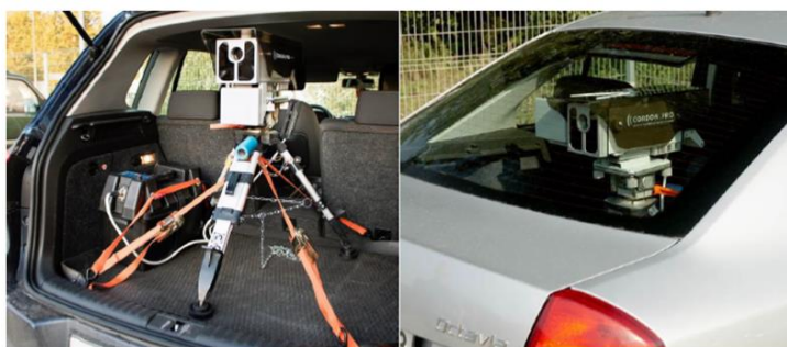
Slika 7. Primjeri ugradnje mjerila Cordon.Pro M u dva različita tipa vozila za mjerenje brzine iz pomične točke
